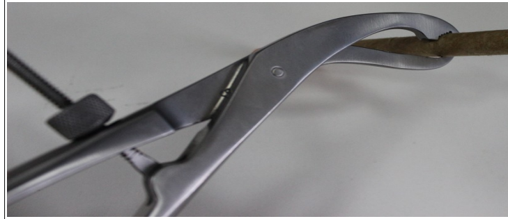
Figura 7: Foto da operação da pinça auto centrante.
